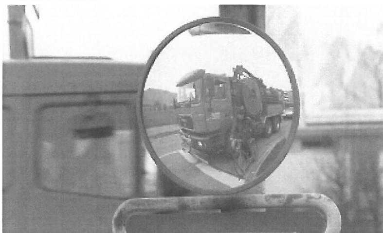
Der Trixi-Spiegel – auf lichtsignalgesteuerten Kreuzungen installiert – gibt dem Lastwagenfahrer einen guten Überblick über die Situation. Bilder: Stadtmobilität Thun
